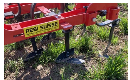
Entlang der Reihen laufen Winkelmesser, mittig wird ein Gänsefussschaar eingesetzt. Der Durchlass pro weite Reihe beträgt ca. 8cm, die Fahrgeschwindigkeit betrug auf vorliegendem Feld 6-8km/ha (6km bei stärkerer Hangneigung).
