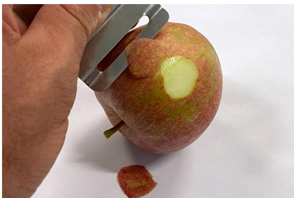
Mit dem Spezialschäler wird die Fruchthaut an den beiden Stellen entfernt, wo gemessen werden soll.
