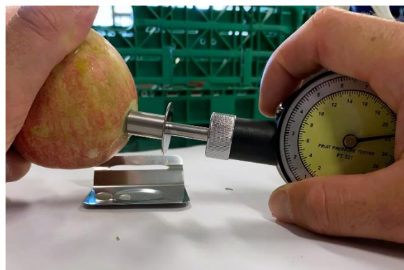
Der Stempel wird mit gleichmässigem Druck bis zur Markierung eingedrückt und gleichzeitig der austretende Saft aufgefangen.
