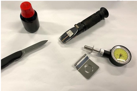
Für die Messungen werden ein Penetrometer, Refraktometer, Jod-Kaliumjodid-Lösung und der Stärkeabbau-Chart des Ctifl benötigt.
