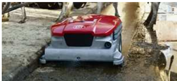
Abbildung 2: Saugende Entmistungsroboter sind eine sehr interessante Alternative zu schiebenden Verfahren.
